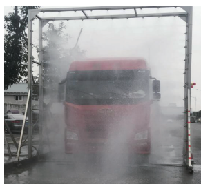
图 4-3 道路车辆消毒通道
